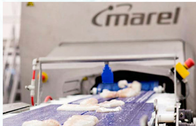
चित्र 2 : मेरल कृत्रिम बुद्धिमत्ता-आधारित मछली प्रसंस्करण मशीन
