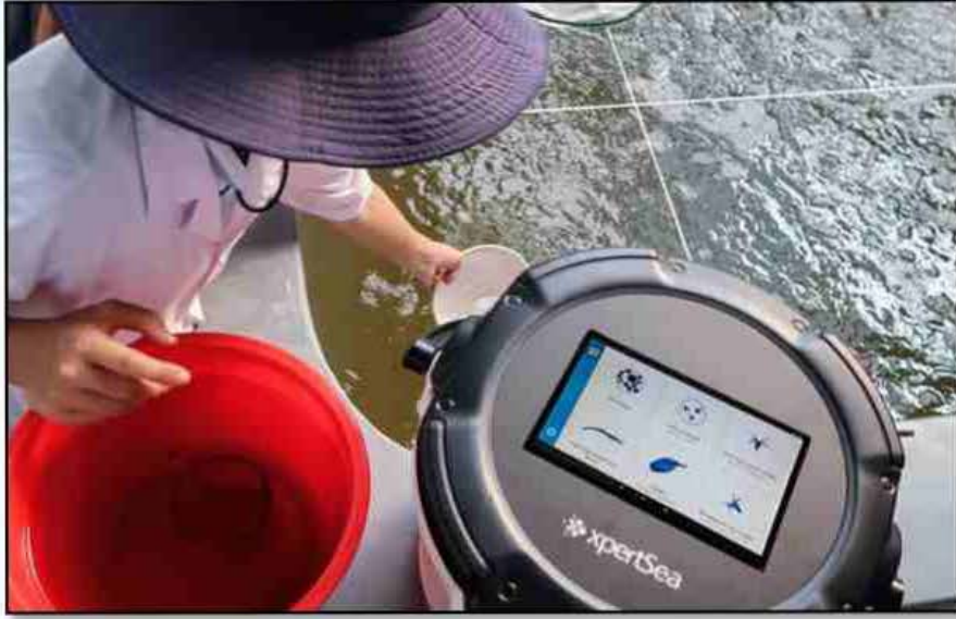
चित्र: कंप्यूटर दृष्टि पर लागू कैमरों और मशीन लर्निंग का उपयोग कर झींगे के आकार, वजन और छवि का निरक्षण करते हुए
